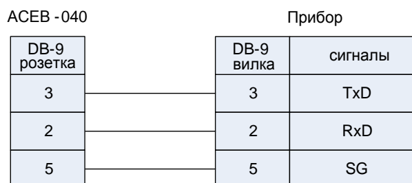
Рис.3. Подключение прибора по интерфейсу RS-232.
