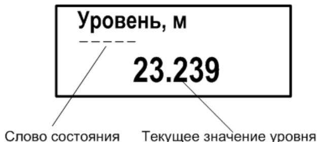
Рис.4 - Вид окна укрупненной индикации измеряемого параметра.
