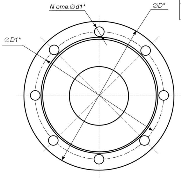
Рис.А.2 - Ответный фланец с патрубком для монтажа уровнемера
