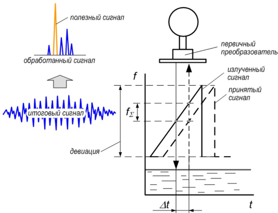
Рис.1 - Принцип действия радарного уровнемера
