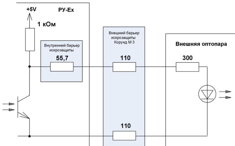
Рис.В.2 - Эквивалентная схема работы на низкоомную нагрузку
