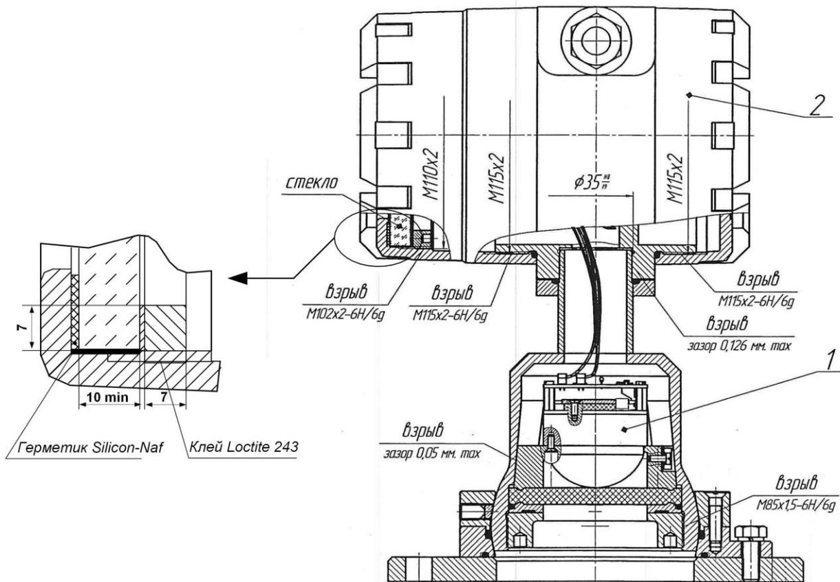
1 – блок первичного преобразователя уровня радарного; 2 – блок вторичного преобразователя.
