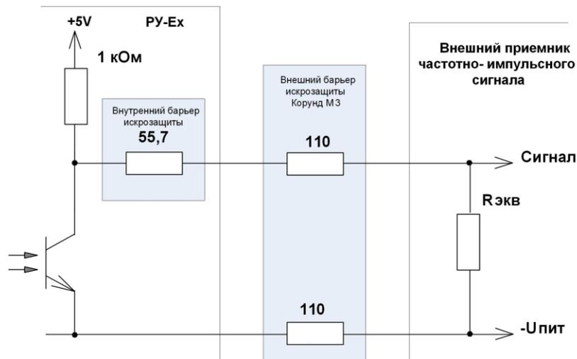
Рис.В.3 - Эквивалентная схема работы на внешний приемник сигнала
