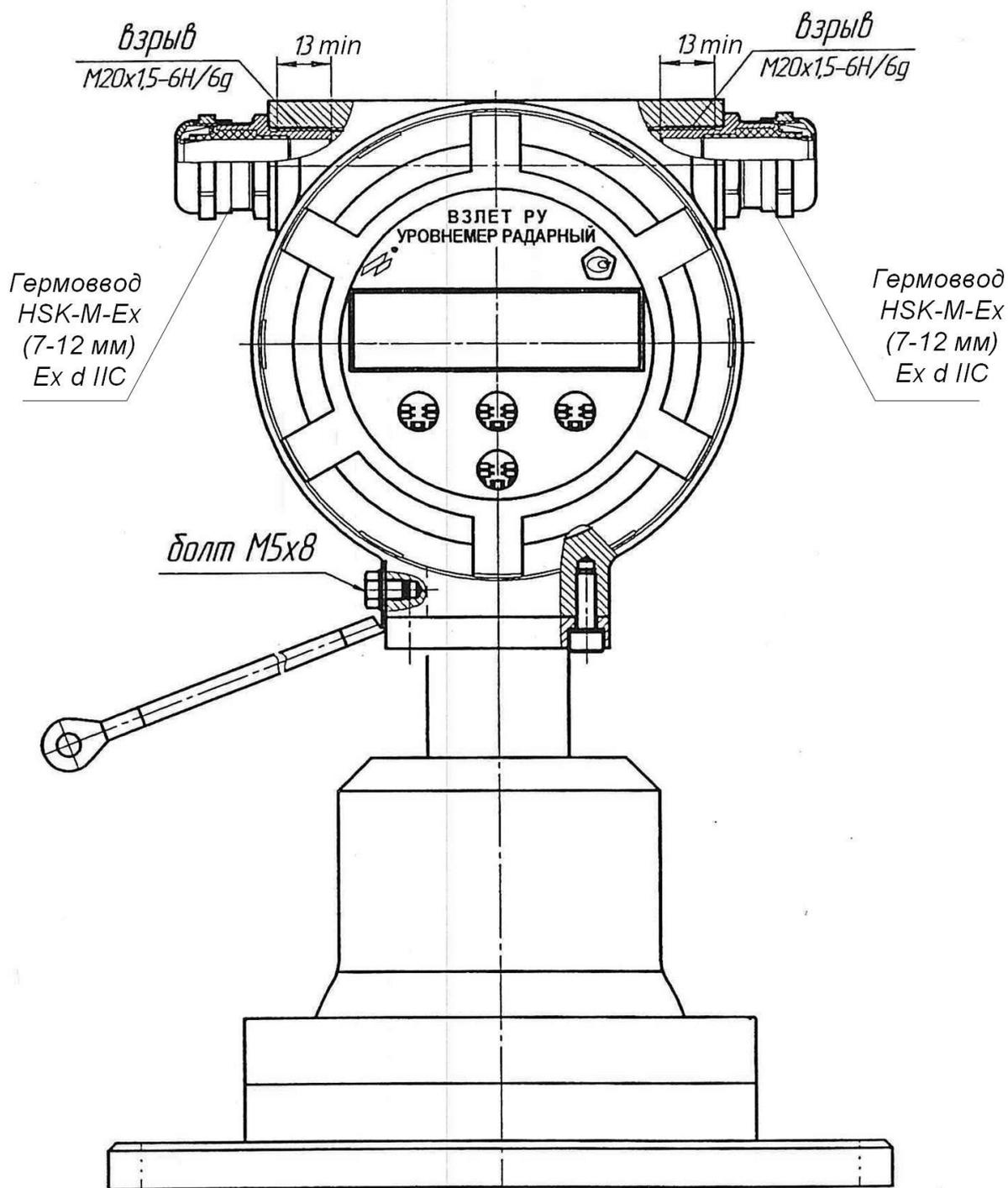
Рис.Б.1 - Взрывонепроницаемая оболочка («d»). Вид спереди
