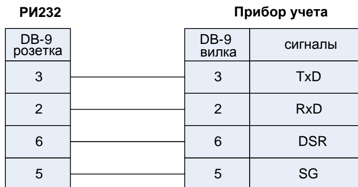
Рис.5. Подключение приборов СПТ943, СПТ943.1.
