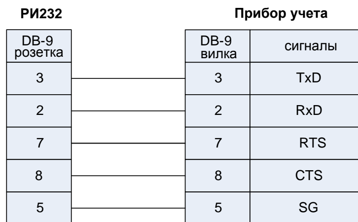
Рис. 4. Подключение приборов СПТ961, СПГ761.
