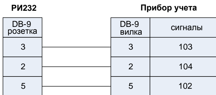
Рис.6. Подключение АПС-45 к адаптеру РИ232.
