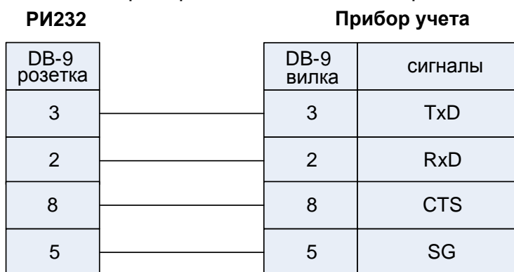
Рис. 7. Подключение ВКТ-5 к адаптеру РИ232.
