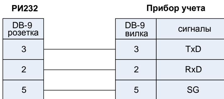
Рис.3. Подключение прибора учета фирмы «Взлет».
