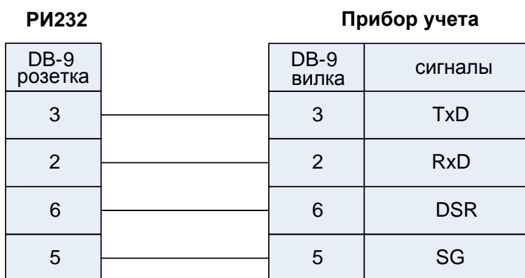
Рис.8. Подключение ВКТ-7 к адаптеру РИ232.
