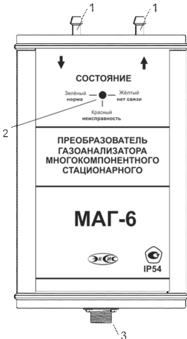
Рисунок 3.7 Измерительный преобразователь с побудителем расхода МАГ-6С
