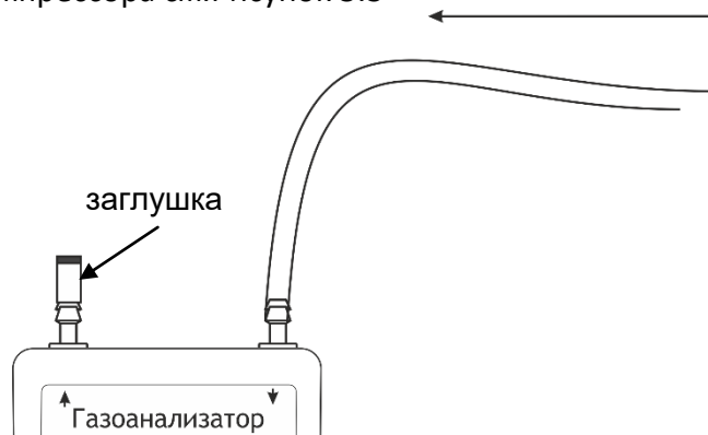
Рисунок 5.3 Непрерывный анализ газа из магистрали (принудительная прокачка)
