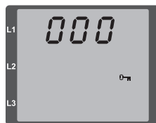
Рис. Запрос на ввод пароля Если задан пароль, его можно ввести с помощью кнопок 1 и 2.
