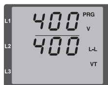
Рис. Режим программирования Трансформатор напряжения С помощью кнопок 1 и 2 можно изменить первичный и вторичный ток (см. стр. 41).
