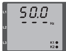
Рис. Установить направление вращающегося поля невозможно.
