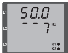
Рис. Индикация частоты сети (50,0) и направления вращающегося поля
