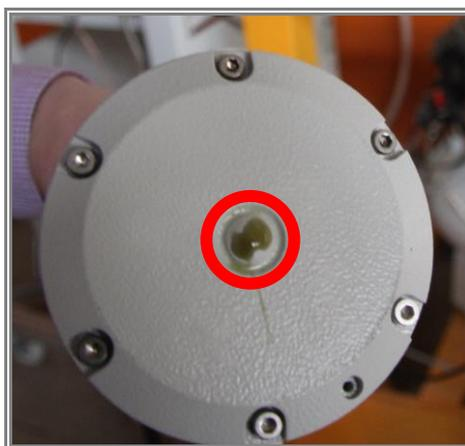
6.5.2. Вставить прибор в пазы монтажной плиты и повернуть по часовой стрелке до щелчка.
