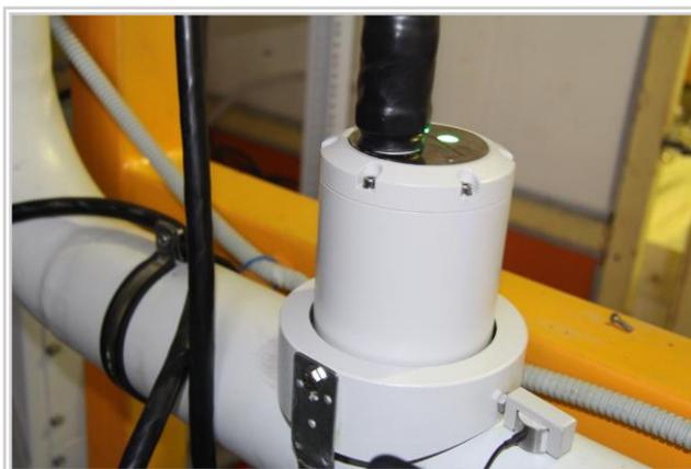
Echo является контактным прибором и устанавливается непосредственно вблизи колена трубы на расстоянии не менее 2х метров от фонтанной арматуры при помощи монтажного основания и стяжного хомута входящих в комплект поставки.
