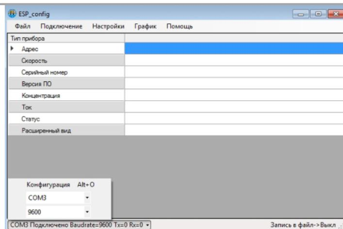
8.2.3. Для быстрого доступа к настройкам СОМ порта, необходимо нажать на кнопку на строке состояния. Для открытия окна с полными настройками порта: Подключение>Конфигурация (ALT+O).
