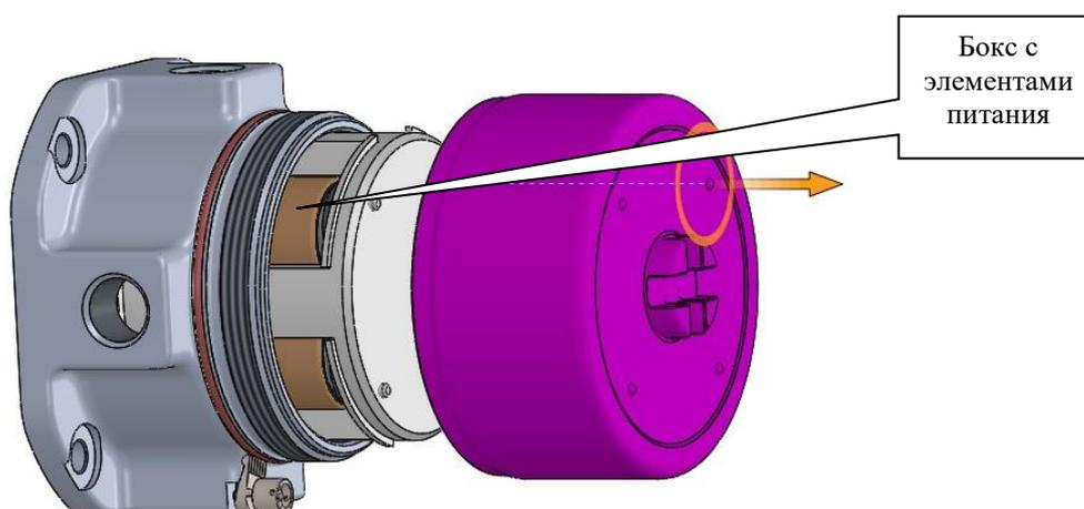
6.3.5. После установки элементов питания GSM модуль автоматически установит связь с ПГУ, произведёт диагностику системы и подключится к сети GSM. После этого выдаётся стартовое SMS сообщение, отображающее состояние системы АСК-ОГП, которое регистрируется принимающим GSM модемом и отобразится в окне программного обеспечения «ЭС GSM мониторинг в.1.0».
