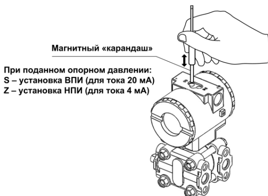
Рисунок 6.1 – Расположение местных регуляторов настройки, отверстие у установки нуля обозначено Z (Zero), диапазона – S (Span)
