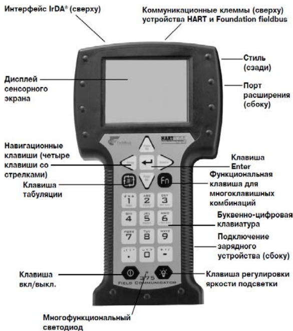
Рисунок Д.1 – Назначение элементов управления коммуникатора модели 375
