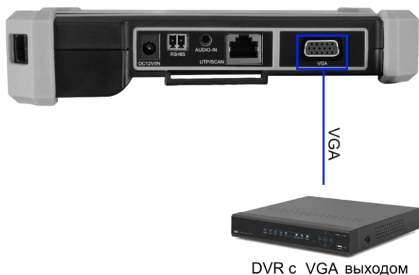
Рис. 11 Подключение VGA устройств к тестеру.
