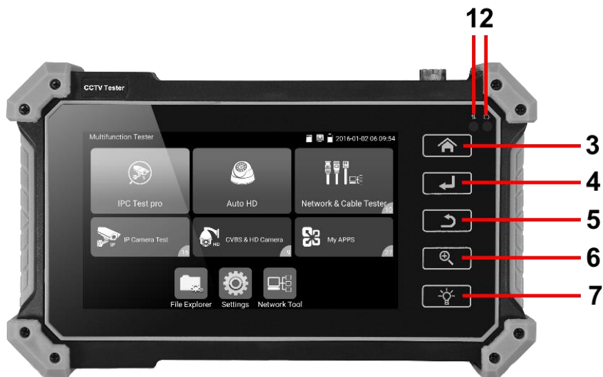
Рис. 3 Тестер TIP-H-5, кнопки и индикаторы на передней панели
