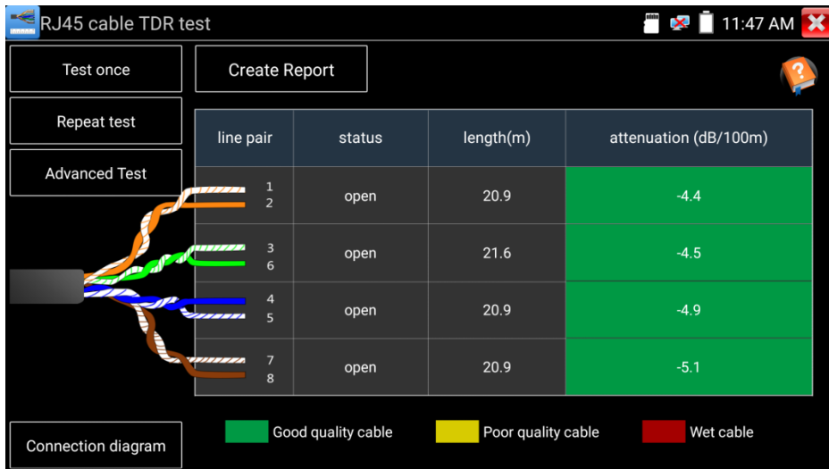
Рис. 102 Интерфейс рефлектометра (TDR) для кабеля «витой пары»
