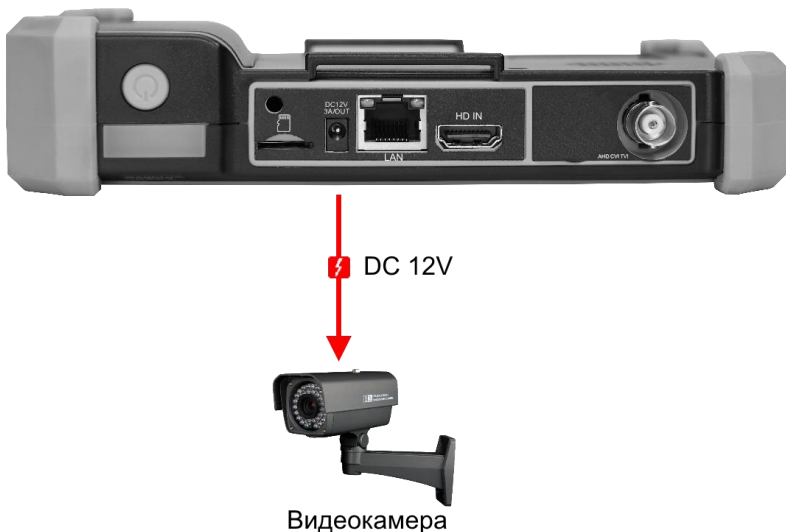
Рис. 8 Подключение питания к IP-видеокамере
