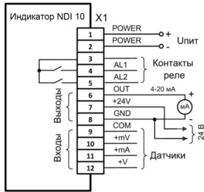
Рисунок 1. Общая схема подключения и контакты разъема.
