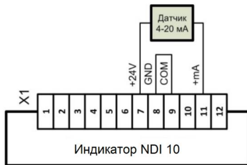
Рисунок 3. Пример подключения 2-х пров. датчика с токовым сигналом 4...20 мА от встроенного в индикатор источника питания (устанавливается перемычка между клеммами 8 и 9).
