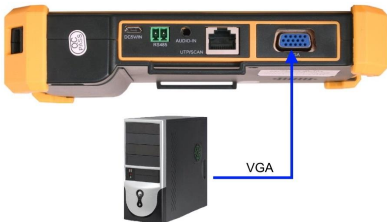
Рис. 14 Подключение устройств к VGA входу тестера
