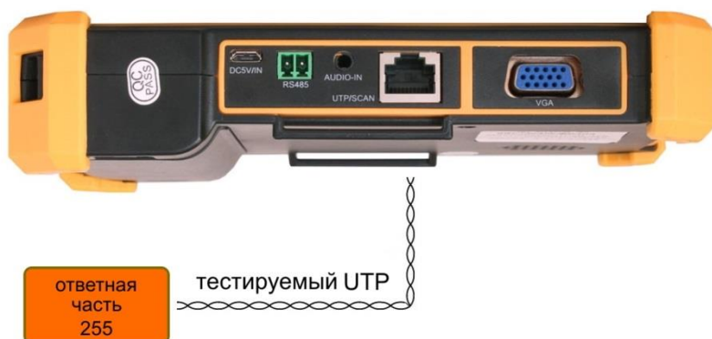
Рис.15 Подключение тестируемого кабеля
