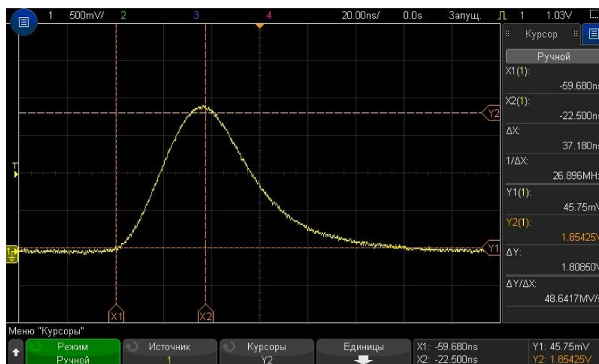
Рис. 41 Использование курсоров для измерения длительности импульса на произвольном уровне
