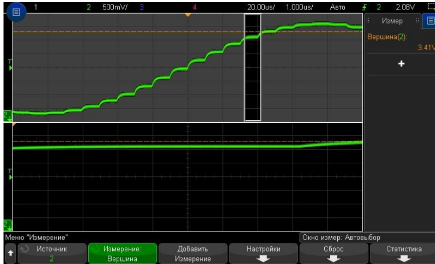
Рис. 47 Выделение области для измерения вершины
