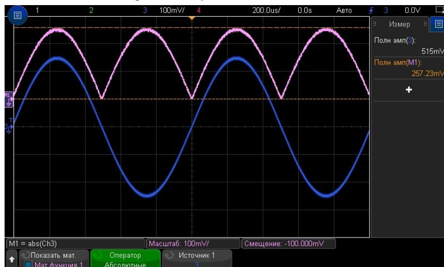
Рис. 13 Пример использования математической функции абсолютного значения Осциллографы КОМЗ АльфаТрек серии С7 Руководство по эксплуатации
