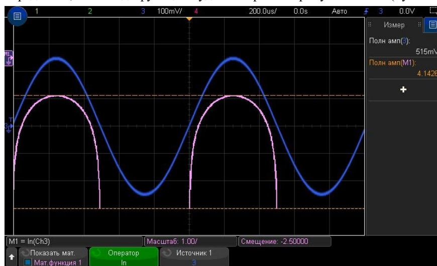
Рис. 14 Пример использования математической функции натуральный логарифм.
