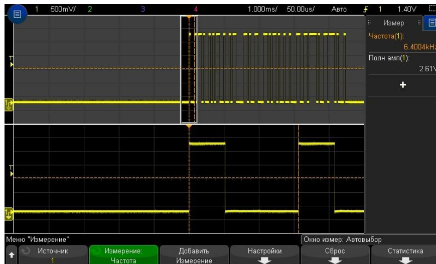
Рис. 49 Выделение события с целью измерения частоты
