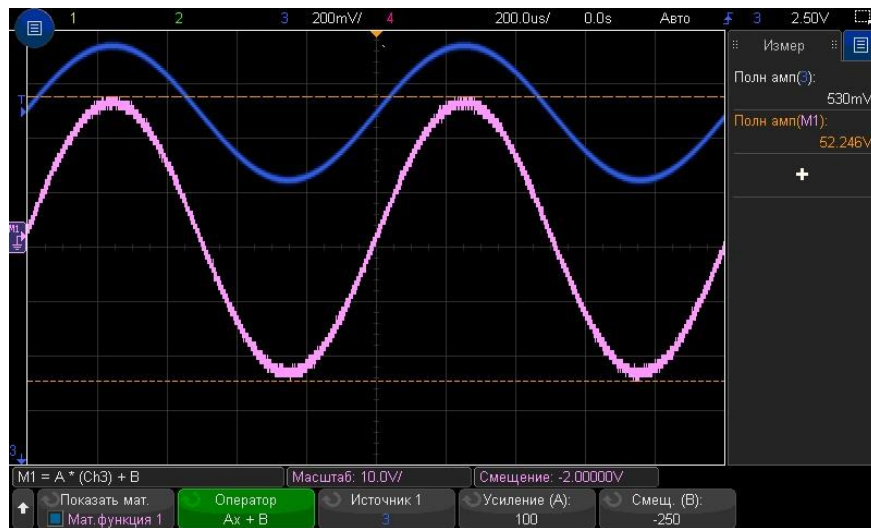
Рис. 12 Пример использования математической функции Ax + B
