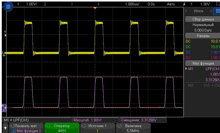
Рис. 16 Пример использования математической функции ФНЧ
