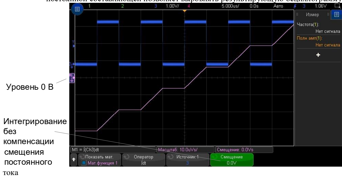
Рис. 9 Интегрирование без компенсации смещения постоянного тока
