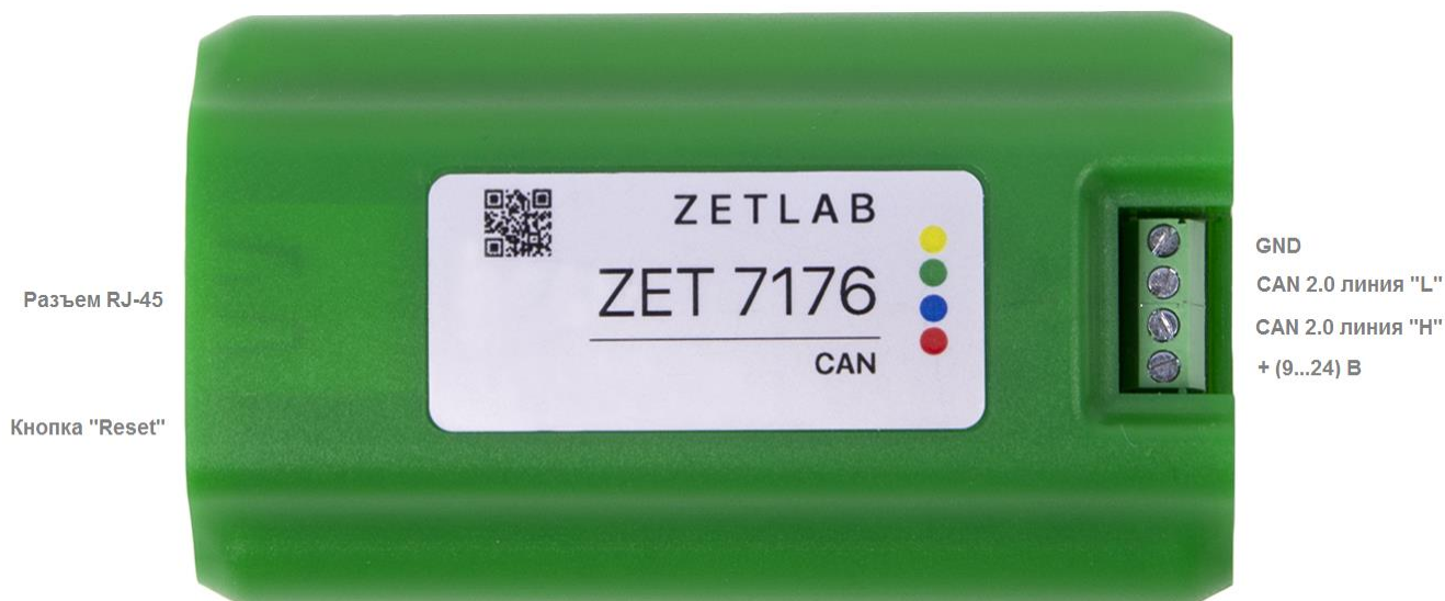
Рис. 2.3 Обозначение контактов ZET 7176 в лабораторном исполнении
