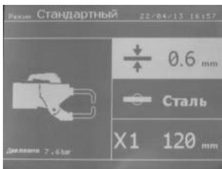
При включении аппарата этот режим афишируется по умолчанию. Он позволяет очень просто совершить сварную точку, выбрав :
