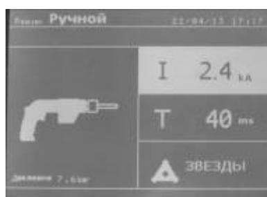
В ручном режиме максимально допустимая сила тока 9 кА в течение промежутка времени, не превышающем 600 мс. Таким образом, настройки на экране будут блокированы на этих максимальных величинах.
