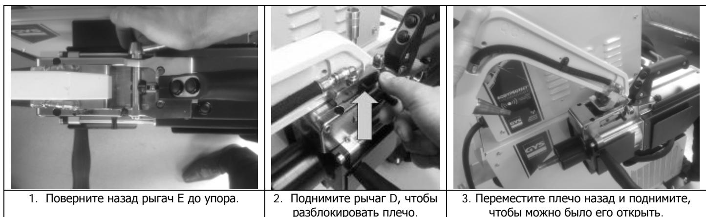
Чтобы снова закрыть плечо, переместите его на опору клещей и используйте рычаг Е, чтобы втолкнуть его в паз. Нажатие на кнопку сварки активирует помпу, аппарат готов к работе.
