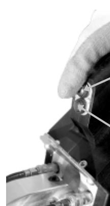
Кнопка Смыкание клещей / Сварка
