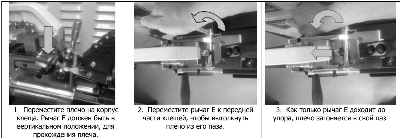
Выйти из режима настройки клещей, чтобы перезапустить помпу и начать сварку.
