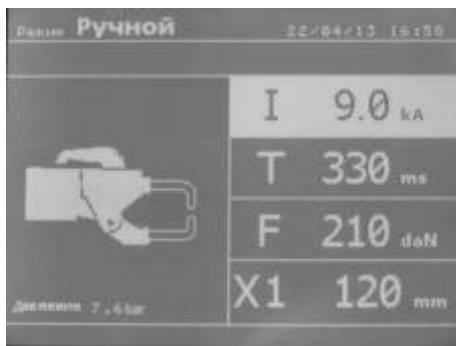
Настройки, предлагаемые по умолчанию в ручном режиме, соответствуют преобразованию настроек, совершенных в нормальном режиме (преобразование толщины и типа металла в ток, в продолжительность и в силу сжатия). Величину параметров можно увеличить с помощью кнопки + и уменьшить с помощью кнопки -. Верхняя и нижняя кнопки позволяют выделить параметр, который нужно изменить, среди следующих:
