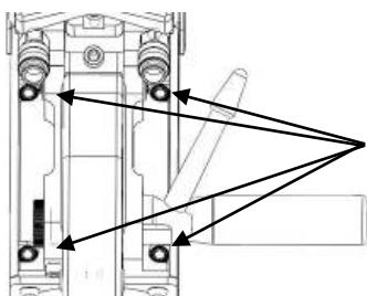
Эти 4 винта обеспечивают крепление основания плеча на корпус клемм ; их правильное затягивание гарантирует хорошую проводимость сварочного тока. Неправильное затягивание приводит к потере сварочного тока и в худшем случае может бесповоротно повредить основание плеча или корпус клемм.
