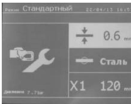
Кнопка позволяет выбрать функцию регулировки клещей. Функция « регулировка клещей » позволяет сократить время на проверку выравнивания электродов. Клещи остаются замкнутыми на протяжении всего времени, что оператор нажимает на гашетку. Эта функция позволяет проверить центровку наконечников.
