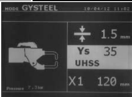
Этот режим GYSTEEL такой же как и стандартный режим за исключением того, что пользователь вводит предел упругости листов. Это Re можно узнать с помощью твердомера, например такого, как Gysteel Vision.
