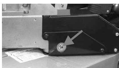
Указанный здесь винт отвечает за фиксацию медных кабелей через которые идет ток в клеммах. Ежемесячно проверяйте, хорошо ли затянут этот винт. В противном случае необратимые повреждения могут возникнуть в соединениях внутри клемм.
