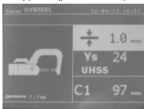
Этот режим авто идентичен стандартному режиму, но пользователь сам вводит предел упругости металла. Это Re можно узнать с помощью такого твердомера, как Gysteel Vision.
