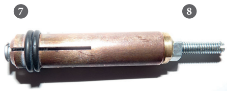
Puntale in rame con 4 fessure per saldare perni in alluminio M4 (diametro \varnothing 4 mm)
