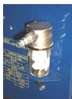
Пневматический фильтр, подключение к пневматической системе
