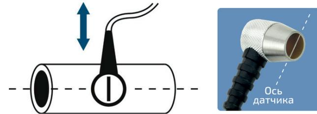
**Для измерения диаметра цилиндра** — необходимо, кроме подготовки поверхности и нанесения связующего вещества, во время измерения установить ось датчика перпендикулярно оси цилиндра, и перемещая датчик по оси (результат будет меняться) — минимальное значение будет соответствовать диаметру цилиндра.
