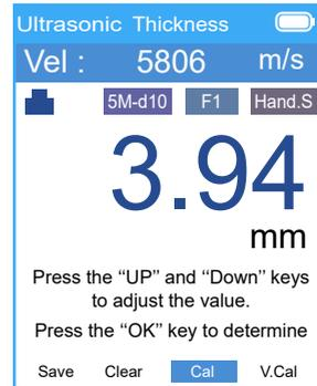
Измерьте толщину образца с точностью 0,01 мм. Кнопками **(UP)** или **(DOWN)** установите это значение. Далее нанесите тонкий слой контактного геля на поверхность датчика. Прижмите датчик к поверхности материала и нажмите кнопку **(OK)**. Прибор вычислит реальную скорость звука в исследуемом образце и её пересчитает.
