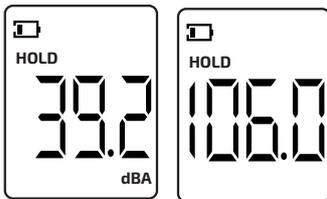
Прибор на дисплее будет показывать установленный уровень сигнализации в дБА. Кнопками **(MIN / MAX)** и **(HOLD)** установите необходимое значение, коротко нажмите кнопку **(U/Y)** для подтверждения установки и перехода в режим измерения. После установки порогового значения при его превышении будет включаться подсветка дисплея индицируя превышение порога.
