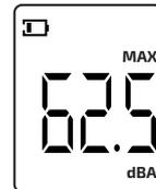
Режимы перебираются по кольцу нажатием кнопки **(MIN/MAX)**. Измерения в режимах фиксации минимального и максимального значений происходят постоянно, пока проводится изме-
