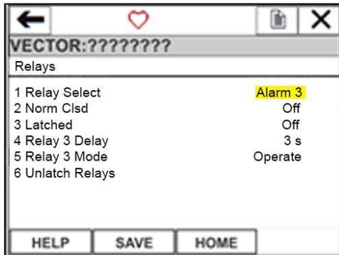
Убедитесь, что напротив функции Relay Select (Выбор реле) стоит значение Alarm 3. В противном случае выберите функцию Relay Select и с помощью клавиш прокрутки выберите значение Alarm 3.
