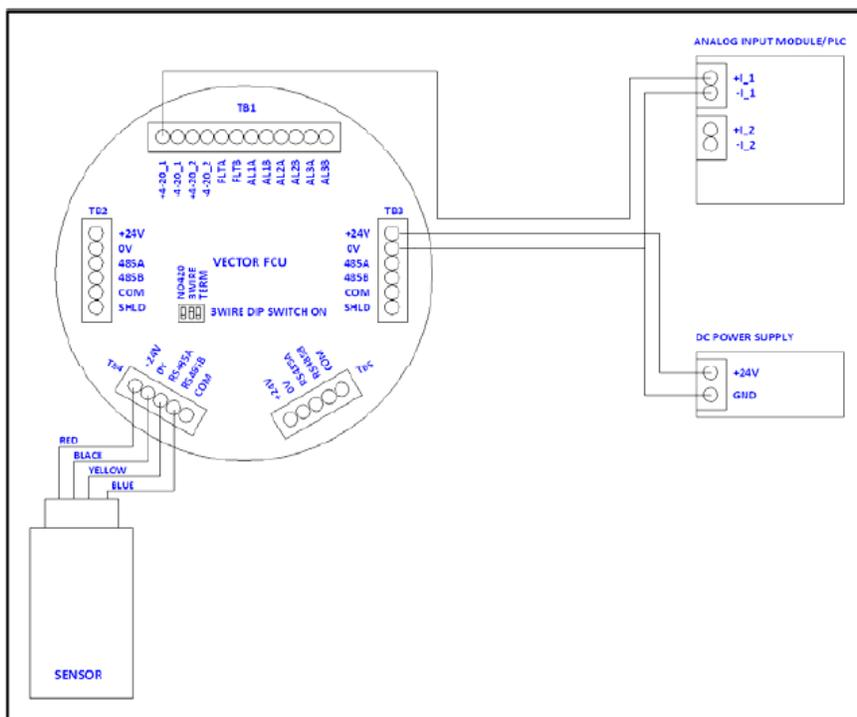
Рисунок 4-13: 3-проводное соединение 4-20 мА с газоанализатором Vector
