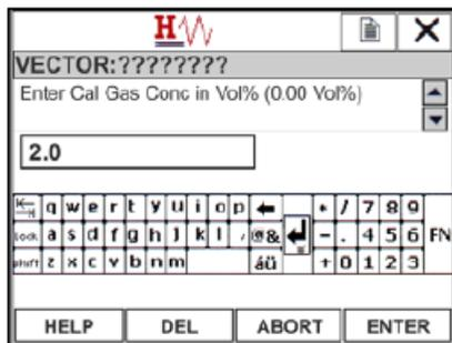
Рисунок 5-22: Ввод данных по концентрации поверочного газа
