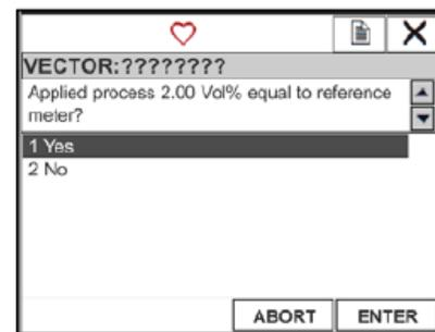
Рисунок 5-23: Подтверждение калибровки поверочным газом
