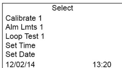
С помощью магнита выберите кнопку Start (Пуск). Для просмотра доступных функций используйте кнопки прокрутки ВВЕРХ/ВНИЗ. Используйте стрелку для прокрутки вниз до функции Set Time (Настройка времени) и нажмите клавишу Select (Выбрать). Появится окно Alarm point (Точка сигнализации).
