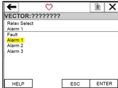
С помощью клавиши прокрутки вниз выберите функцию Alarm Trigger (Запуск аварийных сигналов) и нажмите кнопку Enter (Ввод).
