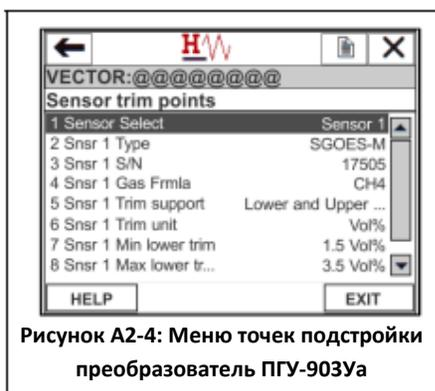
Рисунок A2-4: Меню точек подстройки преобразователя ПГУ-903Уа
