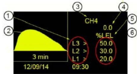
Рисунок 4-2: Одиночный дисплей для отображения информации по газу
