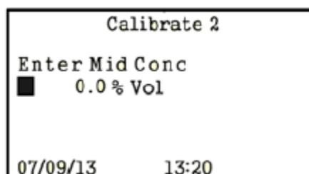
Рисунок 5-5: Ввод значения концентрации среднего поверочного газа
