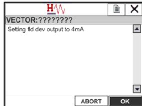
Рисунок 5-34: Настройка значения выходного сигнала 4 мА
