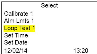
С помощью магнита выберите кнопку Start (Пуск). Для просмотра доступных функций используйте кнопки прокрутки ВВЕРХ/ВНИЗ. Используйте стрелку для прокрутки вниз до функции Loop Test 1 или 2 (Тестирование контура 1 или 2) и нажмите клавишу Select (Выбрать). Если подключен только один преобразователь ПГУ-903У, то функция Loop Test 2 отображаться не будет.
