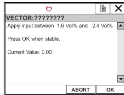
Рисунок 5-21: Калибровка поверочным газом
