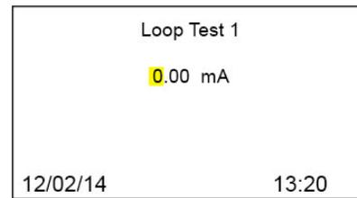
Используйте кнопку Start для перемещения от цифры к цифре и с помощью прокрутки вверх/вниз задайте нужные значения. После установки последней цифры снова нажмите кнопку Start (Пуск), и нужное значение выходного тока появится на реле.
