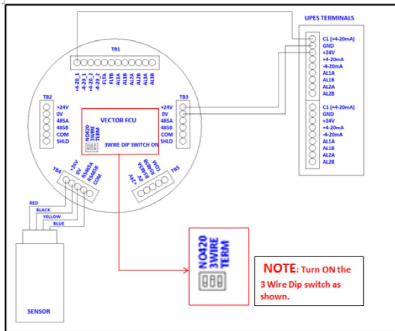
Рисунок 4-11: Подключение газоанализатора Vector ко вторичному устройству S
