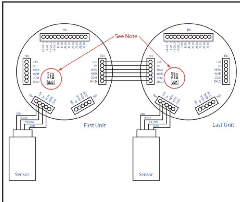
Рисунок 4-14: Подключение газоанализаторов в шлейф по RS-485
