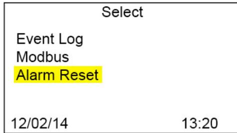
С помощью магнита выберите кнопку Start (Пуск). Для просмотра доступных функций используйте кнопки прокрутки ВВЕРХ/ВНИЗ. Используйте стрелку для прокрутки вниз до функции Alarm Reset (Сброс сигнализации). Нажмите клавишу Start для сброса сигнализации.
