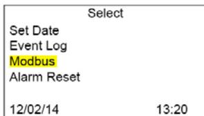
С помощью магнита выберите кнопку Start (Пуск). Для просмотра доступных функций используйте кнопки прокрутки ВВЕРХ/ВНИЗ. Используйте стрелку для прокрутки вниз до функции Modbus и нажмите клавишу Select (Выбрать).
