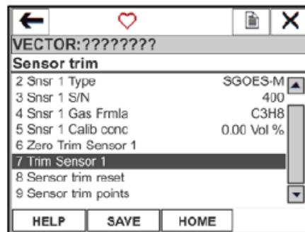
Рисунок 5-18: Экран подстройки преобразователя ПГУ-903У (поверочный газ)
