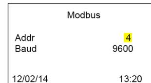
Нажмите кнопку Start для перемещения к первой цифре, затем с помощью стрелки задайте нужные значения. Перемещайтесь от цифры к цифре с помощью кнопки Start. Адрес и скорость передачи данных меняются одинаково.
