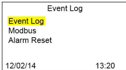
С помощью магнита выберите кнопку Start (Пуск). Для просмотра доступных функций используйте кнопки прокрутки ВВЕРХ/ВНИЗ. Используйте стрелку для прокрутки вниз до функции Event Log (Журнал событий) и нажмите клавишу Select (Выбрать).
