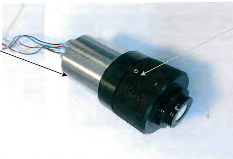
Рисунок 1 – Общий вид преобразователя газоаналитического универсального ПГУ-А без цифрового табло, схема пломбировки от несанкционированного доступа, обозначение места нанесения знака поверки
