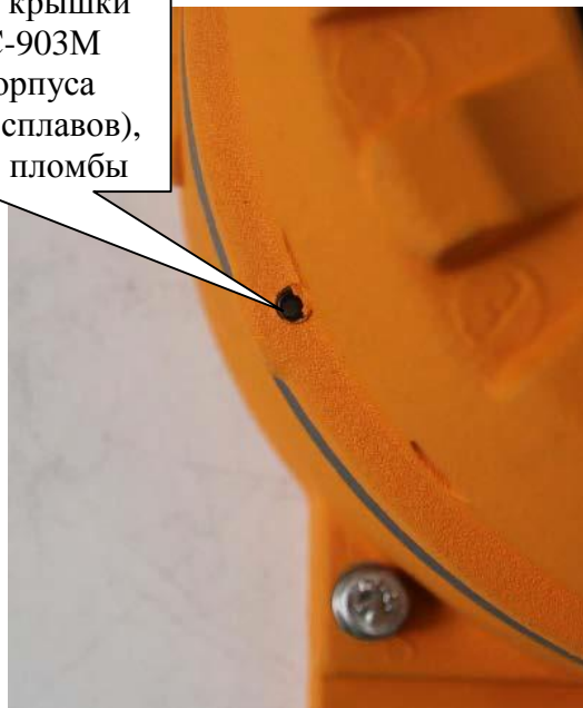
Рисунок 2 - Схема пломбировки газоанализаторов от несанкционированного доступа
