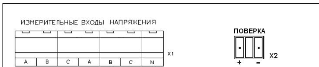
Рисунок Б.6 – Расположение элементов измерительного клеммного отсека приборов «Ресурс-ПКЭ-2.Х-ои-Х»
