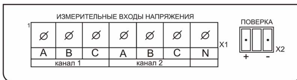
Рисунок Б.3 – Расположение элементов измерительного клеммного отсека приборов «Ресурс-ПКЭ-2.Х-ви-Х»
