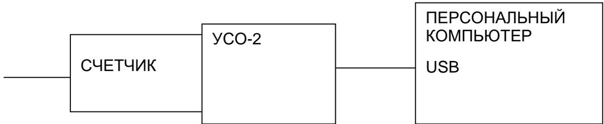
Рисунок А.1 – Блок-схема подключения счетчика с оптическим портом к IBM PC
