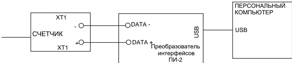
Рисунок А.2 – Блок-схема подключения счетчика с RS-485 к IBM PC
