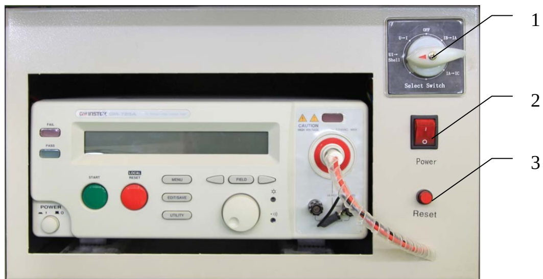
1 - Переключатель включения Установки НЕВА-Тест и выбора параметра тестирования, 2 - Переключатель «POWER» - включение Установки НЕВА-Тест, 3 - Кнопка «Reset» - сброс звуковой сигнализации пробоя.
