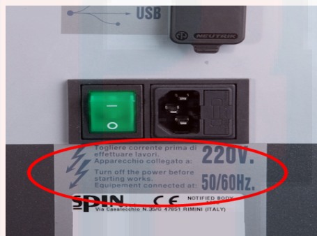
Рисунок 3. Идентификационная табличка содержащая информацию об потребляемом уровне напряжения
