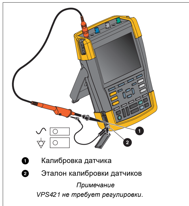
Рис. 48. Регулировка датчика напряжения
