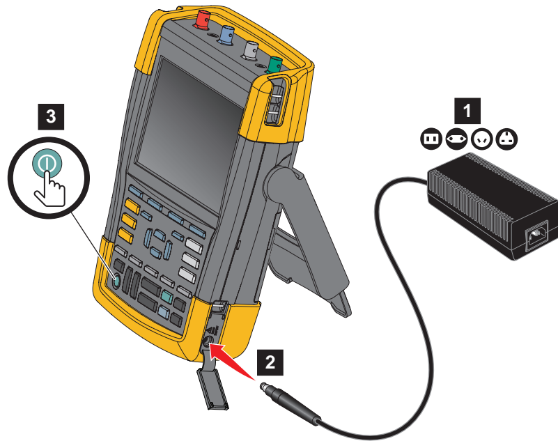
Рис. 1. Подача питания на измерительный прибор
