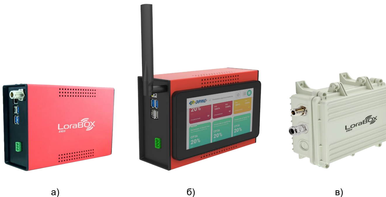
Рисунок 1 – Внешний вид LoraBOX, а), б) – для закрытых помещений; в) – уличное исполнение
