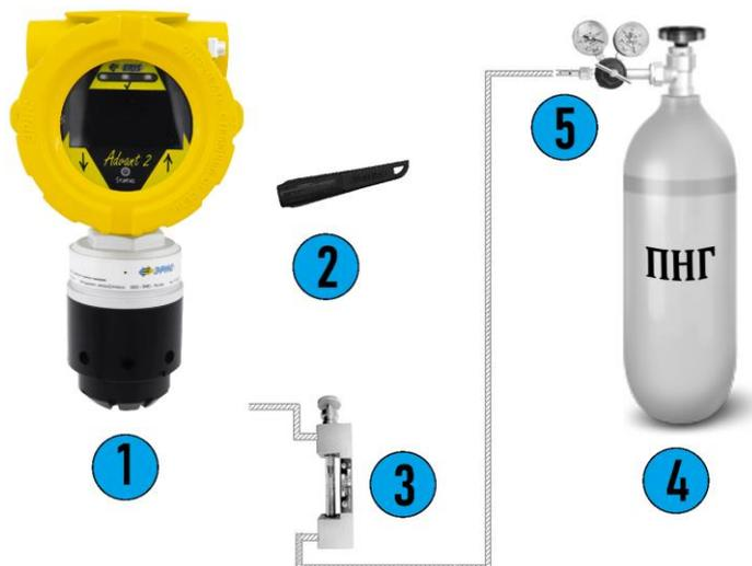
1-Advant 2; 2-магнитный ключ; 3-ротаметр; 4-ПНГ (поверочный нулевой газ) либо заведомо чистая атмосфера без остаточного количества определяемого газ; 5-редуктор.
