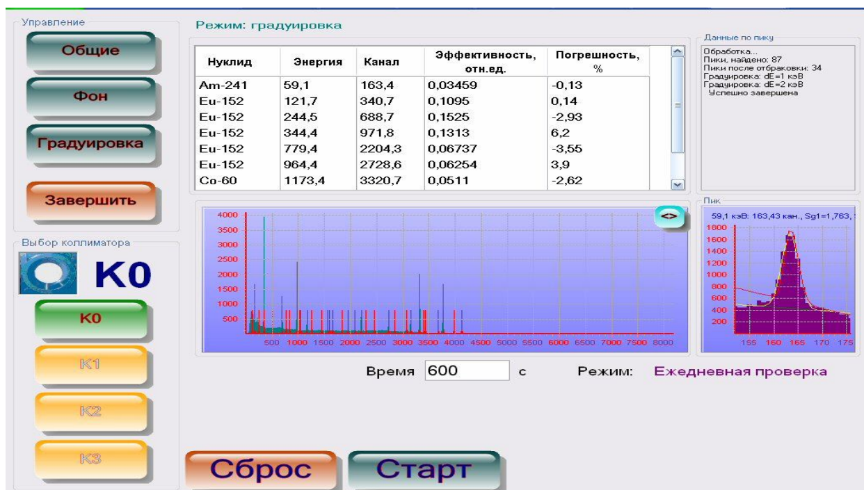
Рисунок 2.6 – Проведение градуировки по энергии
