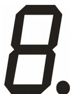
Рисунок 1. 8-сегментный цифровой светодиод
