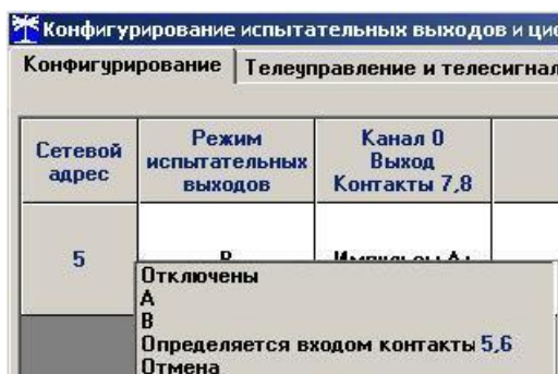
Рисунок 7 - Конфигурирование основного (А) и поверочного (В) режима телеметрии
