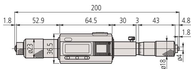
Микрометрическая головка для серии 337
