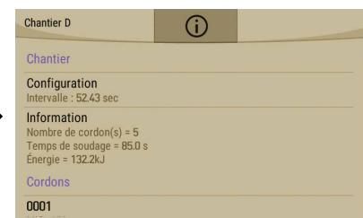
Функция « Explorer » дает доступ к списку созданных рабочих сессий, позволяет их сортировать, а также их удалять. Пиктограмма позволяет детально посмотреть каждую сессию со следующей информацией: частота выборки, количество сохраненных швов, общая продолжительность сварки, энергия сварки, конфигурация параметров каждого шва (метод сварки, автоматическое проставление даты и времени, продолжительность сварки и U-I сварки).
