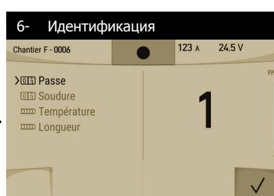
На каждом конце валика отображается окно идентификации: номер прохода, номер сварного шва, комнатная температура и / или длина валика.
