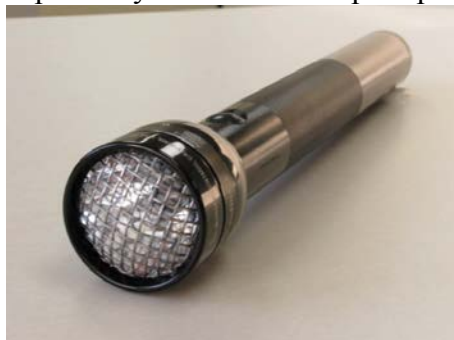
Рисунок 1 – Источник излучения тестовый ИТЭС-М
