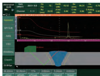
Измерение глубины залегания дефекта
