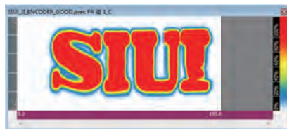
C-развертка, показывает отображение амплитуды
