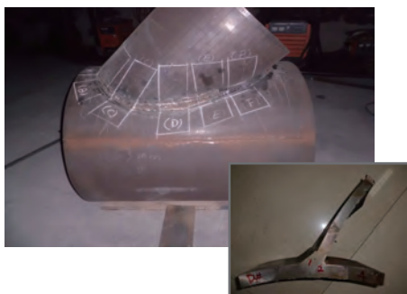
У-образный сварной шов, вырезанный из объекта контроля
