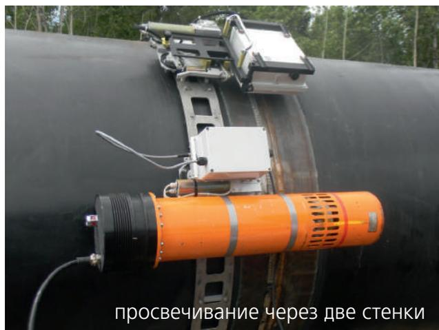
просвечивание через две стенки
