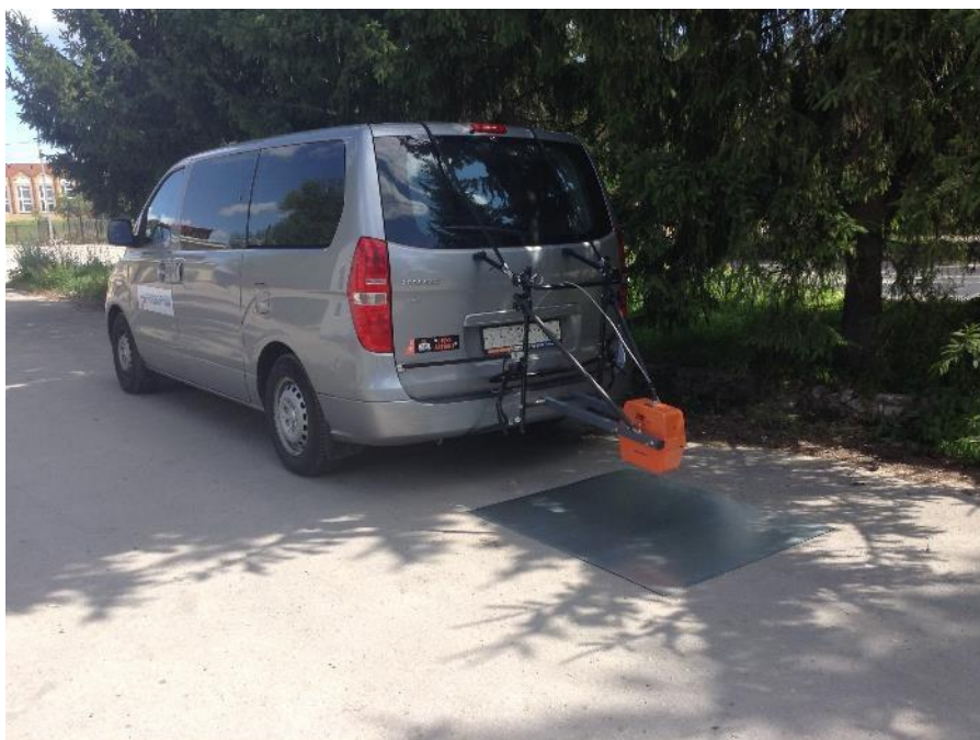
Рис. 2.13. Проведение испытания на металлической пластине
