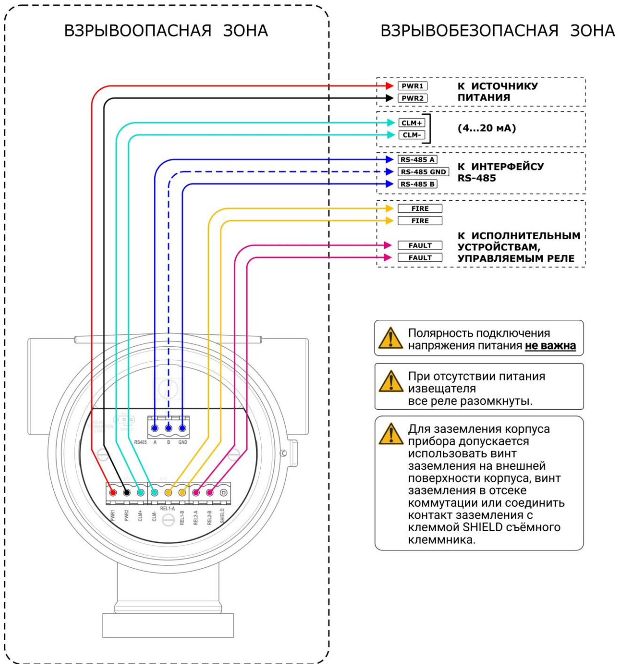
Рисунок Е.1 – Подключение извещателя
