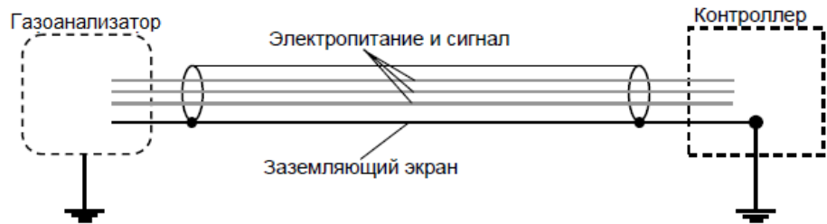
Рисунок 20 – Заземление экранированного кабеля
