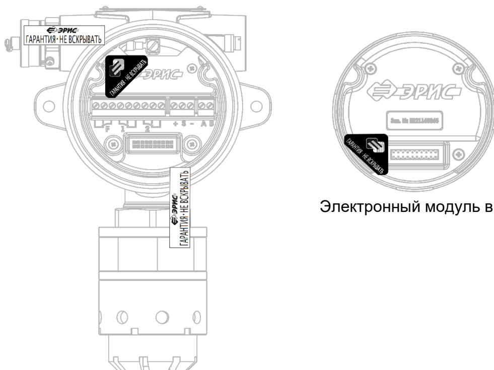
Рисунок 7 - Места нанесения пломб
