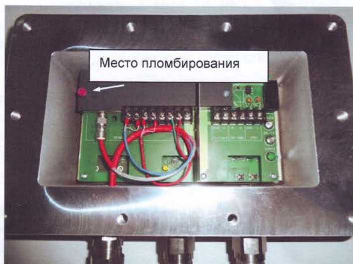
Рисунок 4 – Электронный блок влагомера FIZEPR-SW100 со снятой верхней крышкой. Стрелкой отмечено место пломбирования электронного блока
