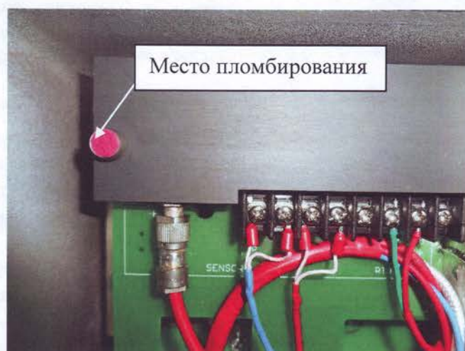
Рисунок 5 – Место пломбирования влагомера
