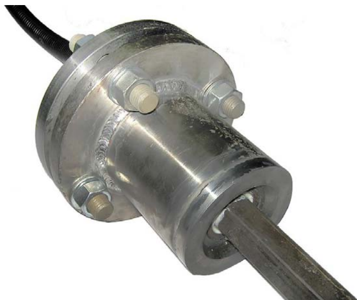
Зонд с передней муфтой в сборе с фланцем
