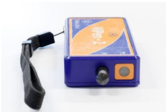
Магнит вкручивается вместо щупа. Магнит не должен закрывать стекло датчика температуры. Магнит ложится на датчик вибрации и не должен касаться корпуса прибора.
