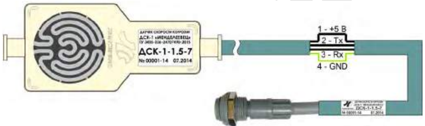
Рисунок А.1 – Схема подключения разъема датчика
