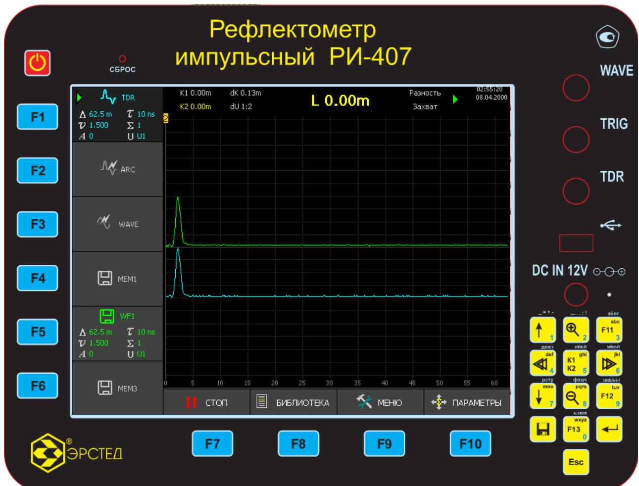
Рисунок 4.4. Лицевая панель прибора РИ-407
