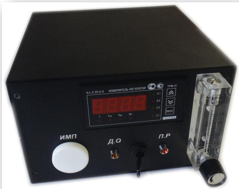
Газодинамический пост ГДП-2 предназначен для создания паровоздушных смесей с примесями целевых веществ в воздухе. Позволяет проводить регламентные работы по настройке, калибровке и поверке газоаналитического оборудования. ГДП-2 обеспечивает приготовление газовых смесей целевого компонента в диапазоне концентраций от  $1 \times 10^{-3}$  до  $100 \text{ мг/м}^3$  (в зависимости от вещества и режима работы) с воздухом или любым другим газом-разбавителем.
