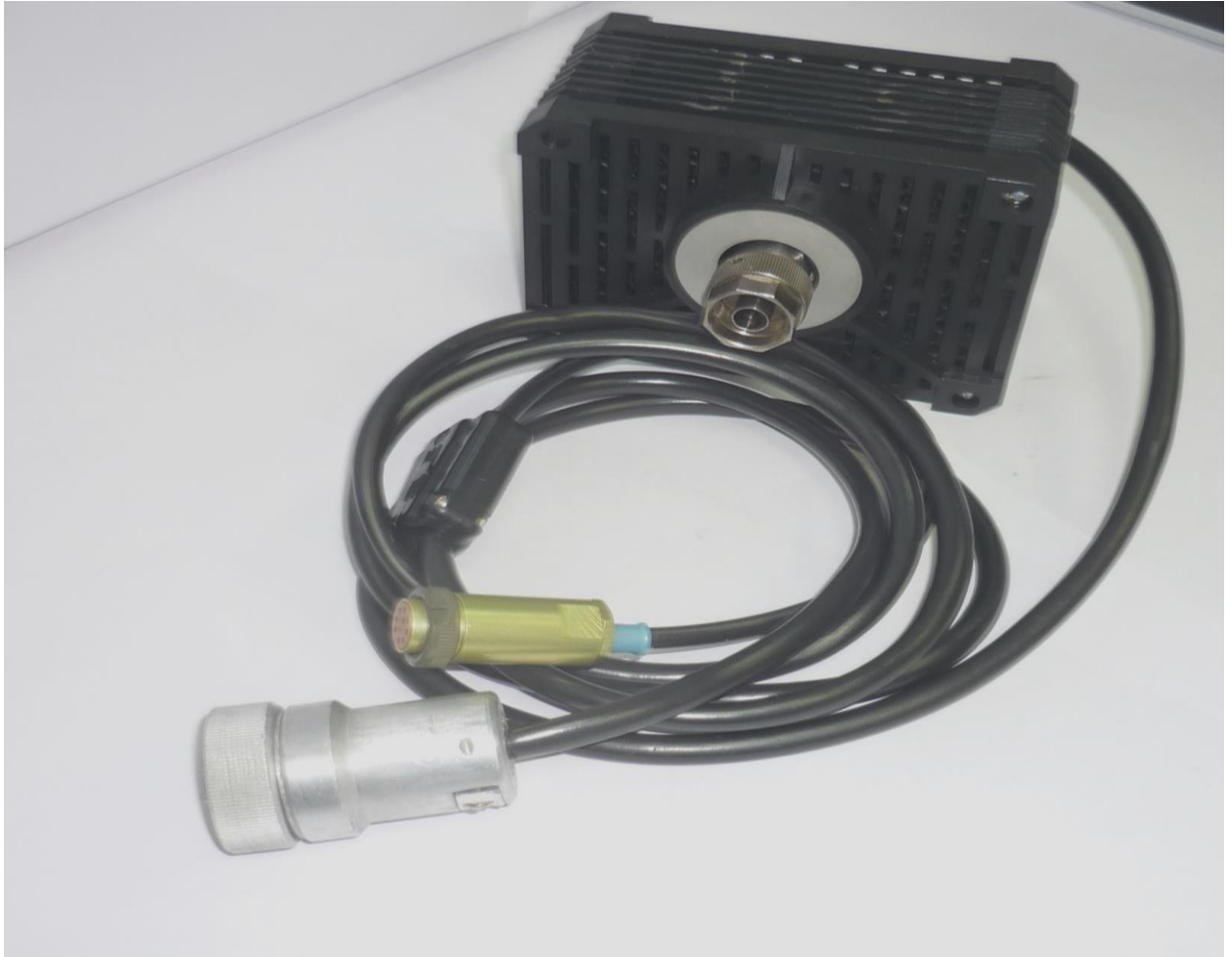
Внешний вид приемного преобразователя коаксиального (ППК) «ПрофКиП М3-95» ПРШН.434849.005 (10 Вт; 0-17,85 ГГц)
