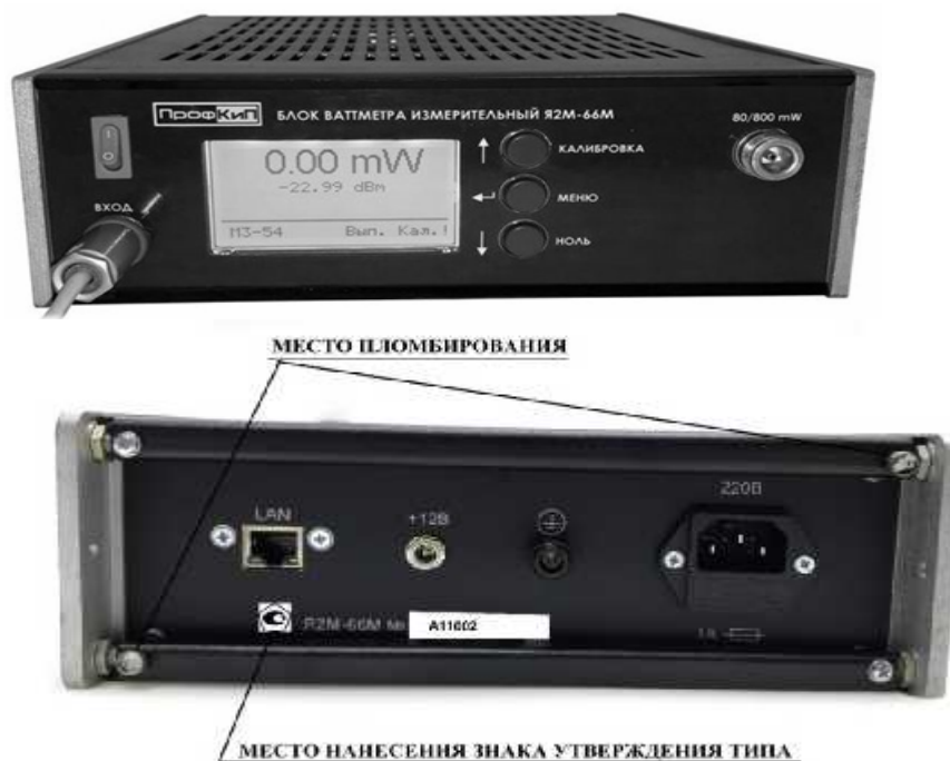
Рисунок 1 - Общий вид блока ваттметра измерительного ПрофКиП Я2М-66М и схема пломбирования от несанкционированного доступа
